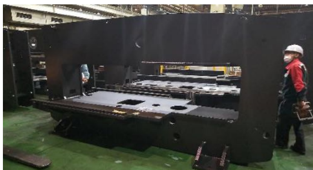
塗装成分見直し品による2回塗装例
